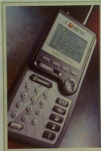
Рис. 3. Compas — портативный прибор комплексной диагностики ЛВС.
