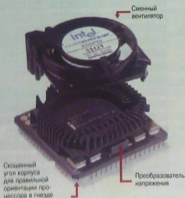
На 63-МГц процессоре Pentium OverDrive установлен сменный вентилятор, в случае поломки которого на экран выдвигается соответствующее сообщение, а рабочая частота снижается до 25 МГц.
