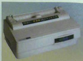
Рис. 4. В струйном принтере Projet 3 фирмы Citizen используются дешевые сменные емкости для чернил.
